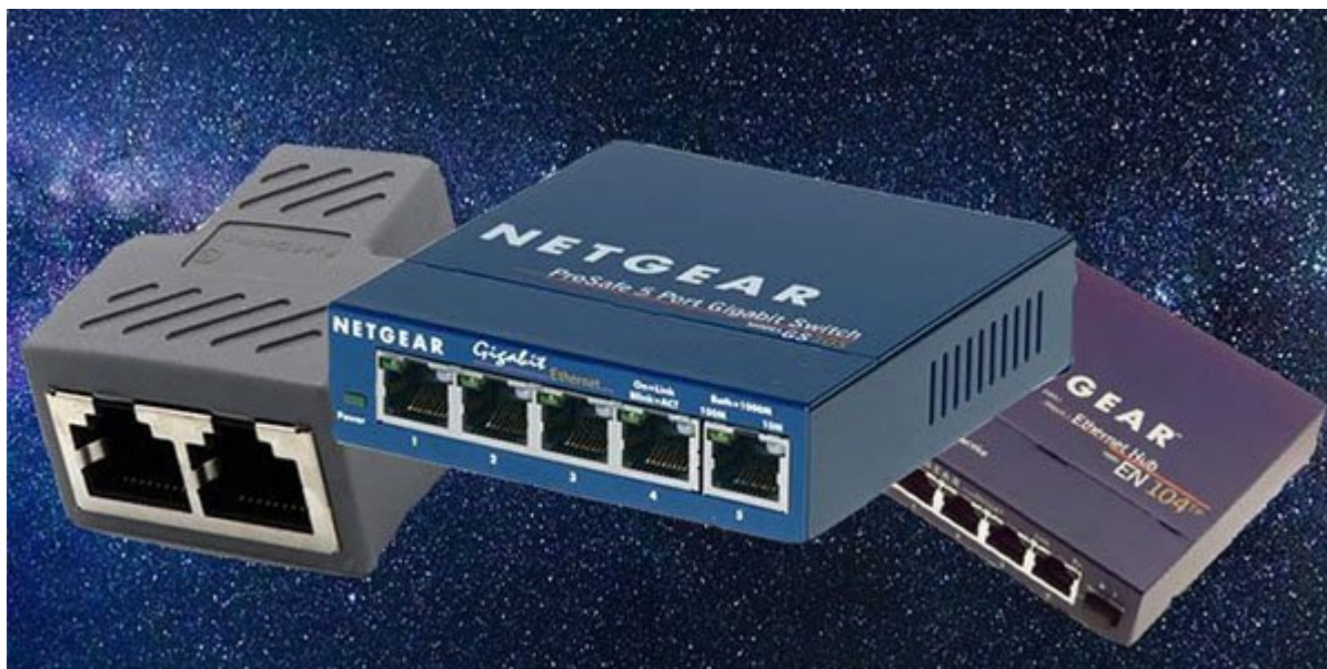
شکل 2. یک دستگاه هاب اترنت در سمت راست و یک دستگاه سوئیچ شبکه در میانه تصویر
