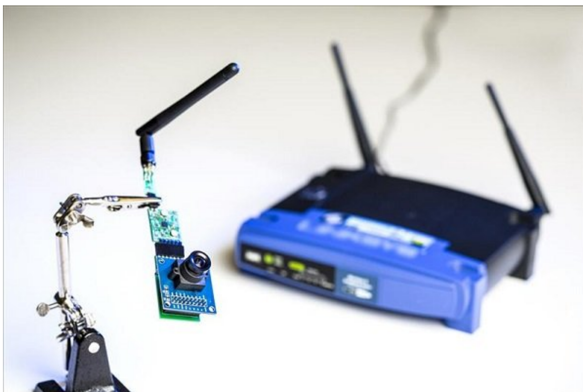
شکل 1 - روترها امواج رادیویی با انرژی میکروویو و منتشر می‌کنند. اگر در سمت گیرنده یک آنتن و مدار الکتریکی مناسب باشد، می‌توان انرژی حامل روی
