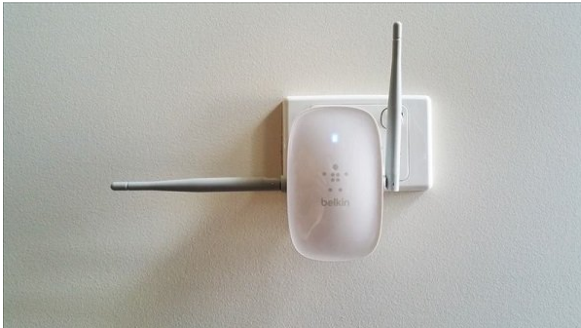
شکل 1 - توسعه دهنده نده وای فای دستگاه ای کوچکی با قابلیت اتصال مستقیم به دیوار خانه هستند که وای فای در آن
