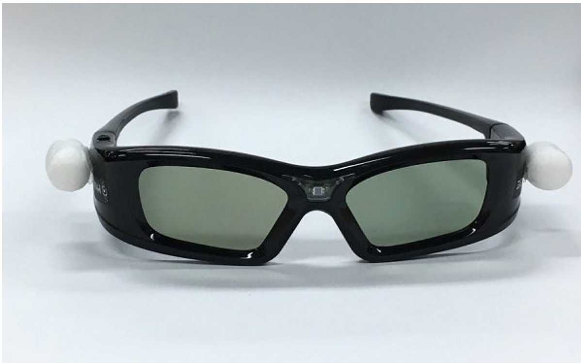
شکل 3 - هر کاربر عینک ویژه ای به چشم می زند که بسیار مشابه عینکها ی سه بعدی است. این عینک مجهز به نشانگر و نیز تراشه های است.
