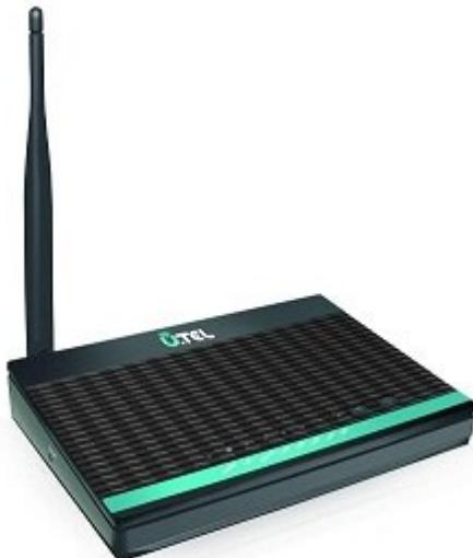
A154 یک مودم روتر سیستم است که از 4 درگاه اتصال 5dBi (Rj45) و یک درگاه تلفن (Rj11) و یک آنتن با قدرت 5dBi بهره می‌برد و یک شبکه داخلی، سرعت 150 مگابیت در ثانیه برای شما فراهم می‌سازد.
